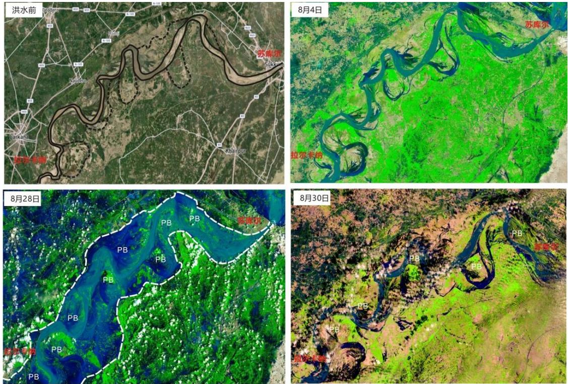
图 2 印度河下游苏库尔至拉尔卡纳曲流河段河道游荡排洪不畅（洪水前、8月4日和28日影像来自 USGS）
